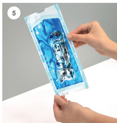
Lassen Sie die Tinte an jeder Siegelnaht ca. 5 Sekunden einwirken. Prüfen Sie alle Siegelnähte auf Dichtigkeit.
